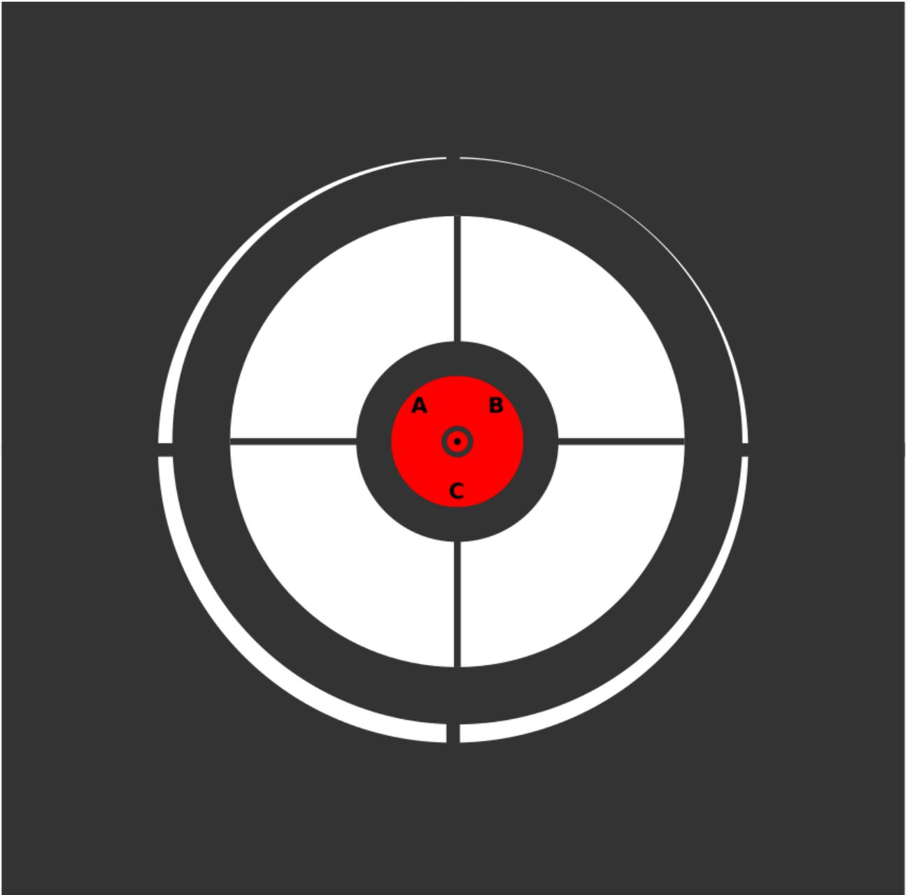
*Rappresentazione di un OTA RC con secondario collimato e primario scollimato.*
