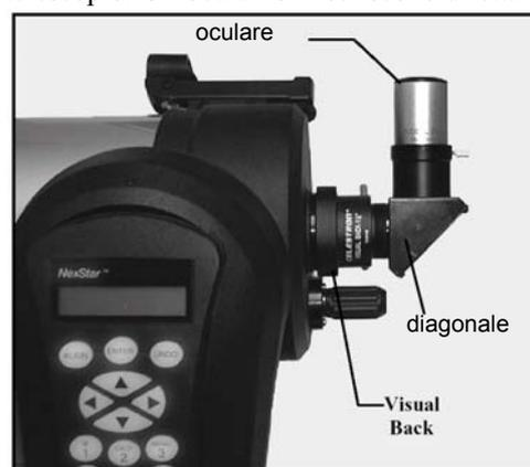
Il diametro del barilotto di un oculare è il diametro del tubetto cromato che si infila nel diagonale o nel foccheggiatore. I diametri standard dei barilotti sono: 24.5mm (obsoleto), 31.8mm (universale) e 50.8mm (dedicato ai grandi telescopi). I telescopi NexStar SE utilizzano oculari e accessori standard diametro 31.8mm.
